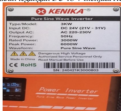
Gambar 13. Spesifikasi Inverter Yang Digunakan pada Penelitian
