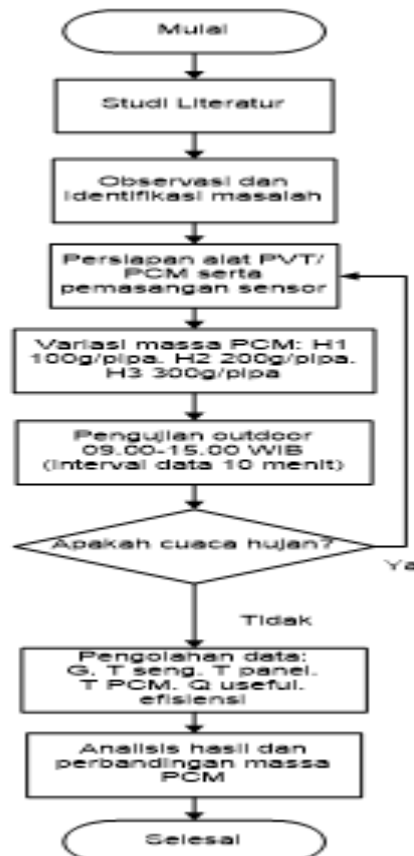
Gambar 2. Diagram alir penelitian kolektor udara PVT-PCM.
