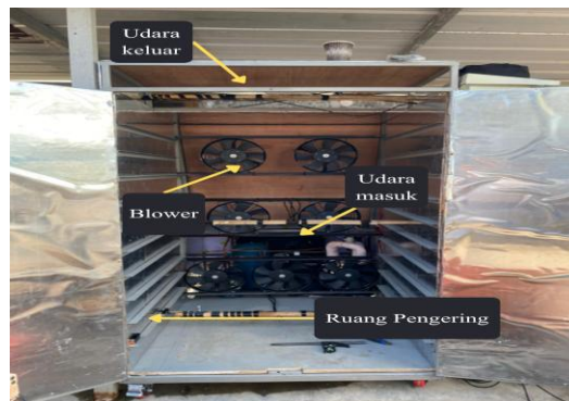
Gambar 1. Alat Pengering Ikan yang Digunakan Dalam Penelitian
