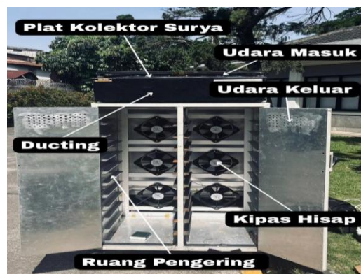
Gambar 1. Solar Drying Chamber Yang Digunakan Dalam Penelitian
