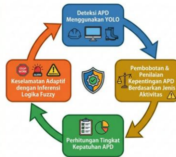
Gambar 1. Alur Kerja Sistem Terintegrasi YOLO-Fuzzy untuk Deteksi APD dan Pengambilan Keputusan Respons Keselamatan Adaptif
